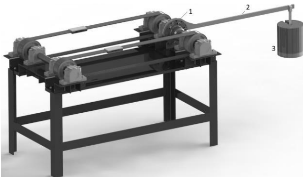
Abbildung 15. Verspannen des Prüfstands a) Aufbringung der Umfangskraft auf eine Kupplungshälfte (1) durch den Drehmomentenhebel (2) und die Massestücke 3 b) Die Gegenkraft wird durch das grüne Halteelement in den Rahmen eingeleitet.
